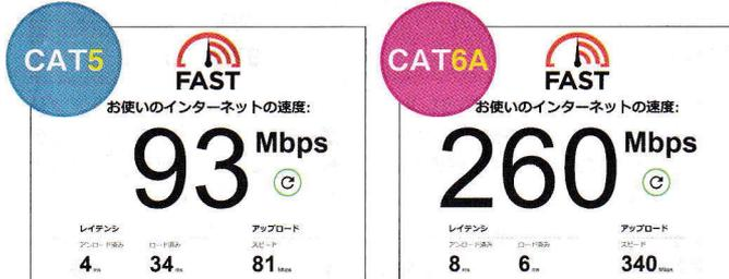
図11 パソコンとWi-Fiルーターを図10のCAT5とCAT6AのLANケーブルでつなぎ、「Fast.com」で実効速度を測った。差は一目瞭然。CAT5は100Mbpsで頭打ちとなり、最大1Gbpsの光回線を全然生かせていない
