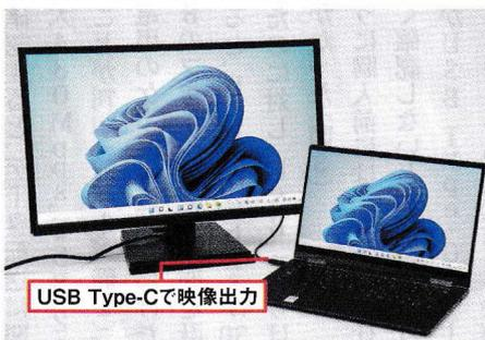
図5 USB Type-Cケーブルで、ディスプレイに映像を出力したい場合は、オルタナティブモード対応が必須。非対応のケーブルもあるので注意したい
