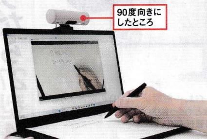
図2 スタンド部分の機構でカメラを簡単に下向きに変更できる。「Showモード」と呼ばれ、手元の資料や手書きメモなどを映したい場合に便利だ
