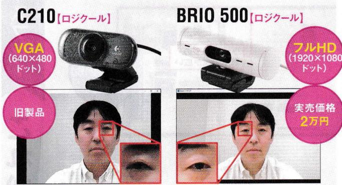
図1 ロジクールの新旧ウェブカメラで画質をチェックした。左は2011年発売の「C210」。右は最新の「BRIO 500」。さすがにVGA(640×480ドット)だと輪郭がぼやけて表情もわかりにくい
