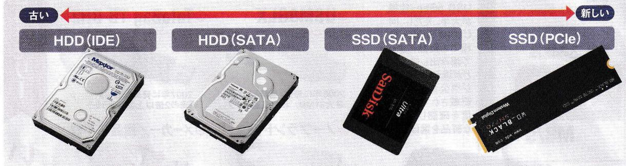
図1 内蔵ストレージも捨てられずにたまっていく周辺機器の1つ。筆者宅には旧規格であるIDE接続のHDDから、現行規格であるSATA接続のHDDやSSD、高速のデータ通信が可能なPCIeのSSDなどまで、3.5型や2.5型などのサイズ違いのものも含め多数転がっていた
