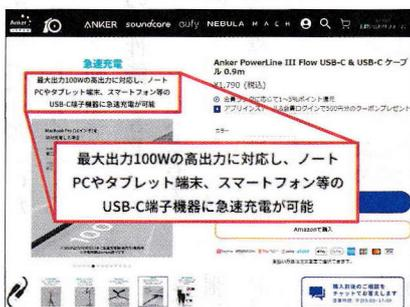
図4 USB PD対応をうたうType-Cケーブルは、最大60Wか100W以上かで大きく分かれる。お薦めは100W以上だが、スマホの急速充電が目的なら60Wでも十分だ
