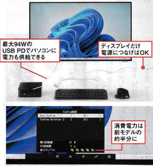
最大94WのUSB PDでパソコンに電力も供給できる
