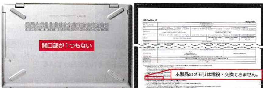
Pavilion 15の底面。ユーザーが内部基板にアクセスできるような開口部は見当たらない。仕様表でもメモリー増設は不可となっている
