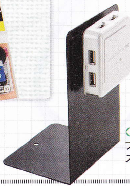
▶ 図4 機器の裏側と本体の側面に面ファスナーを貼り固定。面ファスナーはさまざまな形があるので、機器の形に合わせて選ぶ。外すときは、少しひねると剥がしやすい
