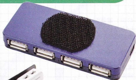
▶ 図4 機器の裏側と本体の側面に面ファスナーを貼り固定。面ファスナーはさまざまな形があるので、機器の形に合わせて選ぶ。外すときは、少しひねると剥がしやすい
