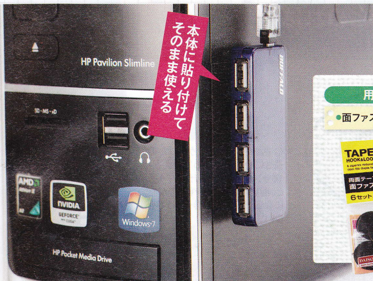
◀ 図3 常にパソコンとつながりっぱなしのUSBハブやカードリーダーなどは置き場所に迷いがち。面ファスナーを使ってデスクトップパソコン本体の側面など、邪魔にならない場所に固定しよう。いつでも着脱可能なうえ、貼ったまま使える
