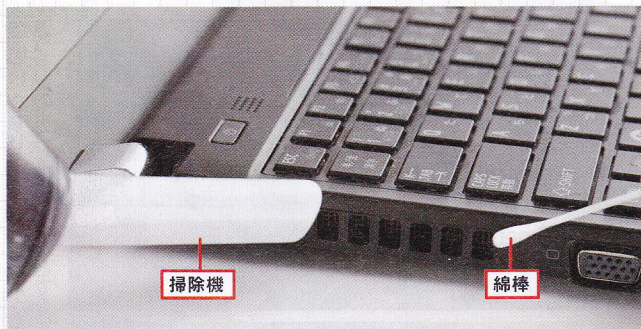
図8 通気口の位置はパソコンの機種によって異なるが、側面や底面にある場合が多い。掃除前によく確認しておこう
