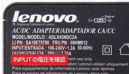
図2 パソコンやデジカメ、スマホの充電器の多くは海外での使用にも対応している。入力(INPUT)欄を確認して「100-240V」とあれば海外でも使える
