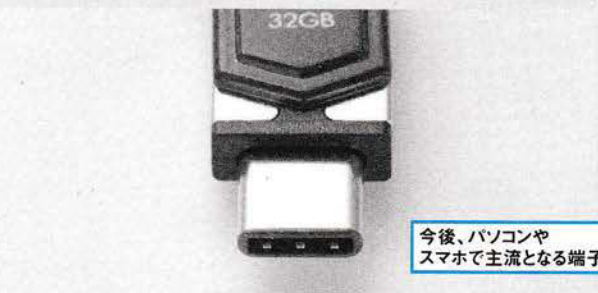
◎ 図11 USBメモリーの中にはアンドロイドのスマホやiPhoneなどに対応した製品もある。変換ケーブルを使わずに、それぞれの端末に直接挿せるため便利だ。なお、転送速度はUSB2.0相当になる
